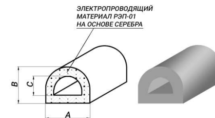
Электропроводящие D-образные полые силиконовые/фторсиликоновые эластомеры ЗИПСИЛ 206 РЭП-01
