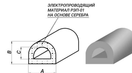
Электропроводящие D-образные сплошные силиконовые/фторсиликоновые эластомеры ЗИПСИЛ 205 РЭП-01
