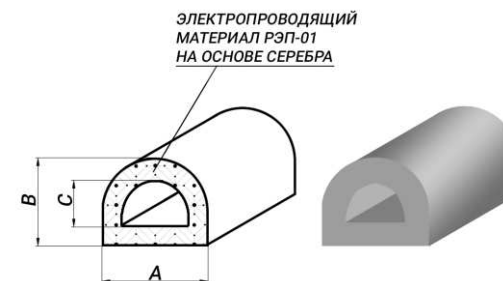
Электропроводящие D-образные силиконовые/фторсиликоновые эластомеры ЗИПСИЛ 206 РЭП-01
